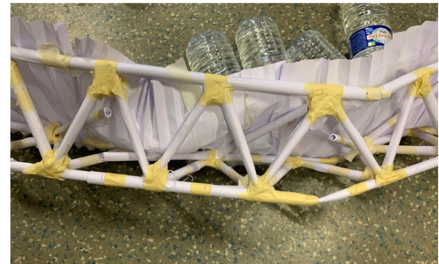
photo du pont après écroulement montrant l'endroit de la rupture
