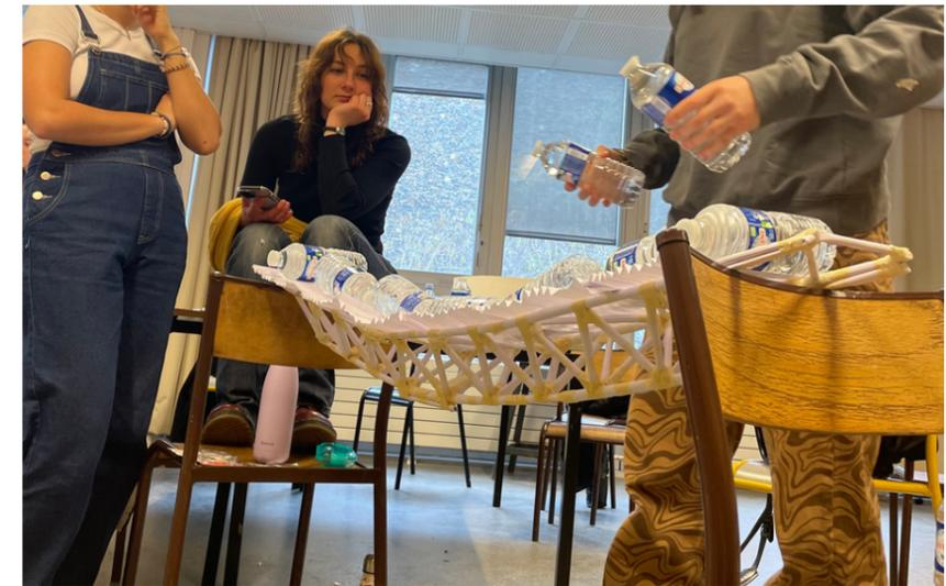
photo du pont pendant position des charges (nous pouvons remarquer un flambement)
