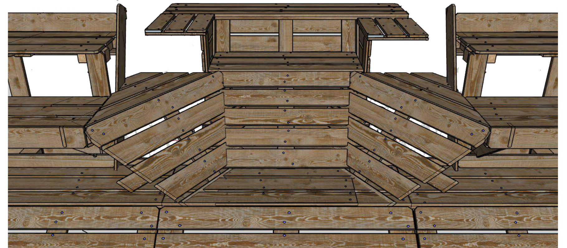
VUE DE LA PROUE HABITÉE PAN DIAGONAUX ET DROIT FORMANT ASSISE ET TABLETTE ELLE REMPLIE AUSSI LE RÔLE DE VIGIE
