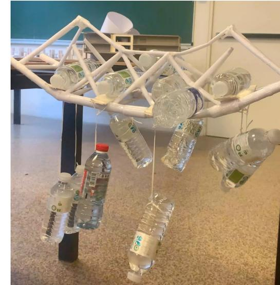
La rupture du pont s'est produite au niveau de la poutre supérieure, en compression. Celle-ci a fléchi des deux côtés opposés. Car les tirants n'ont pas résisté et en se décrochant de la poutre, ils ont cessé de reprendre les efforts qui leurs étaient transmis.
